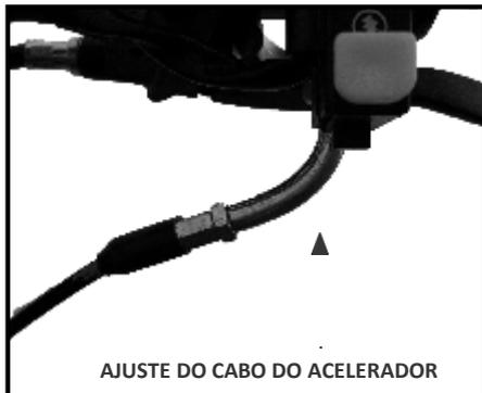
AJUSTE DO CABO DO ACELERADOR
