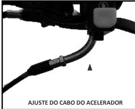
AJUSTE DO CABO DO ACELERADOR
